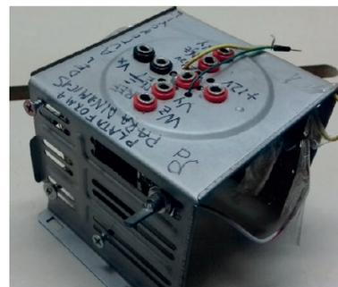
Figura 7: Plataforma digital y de potencia para dirección asistida.
